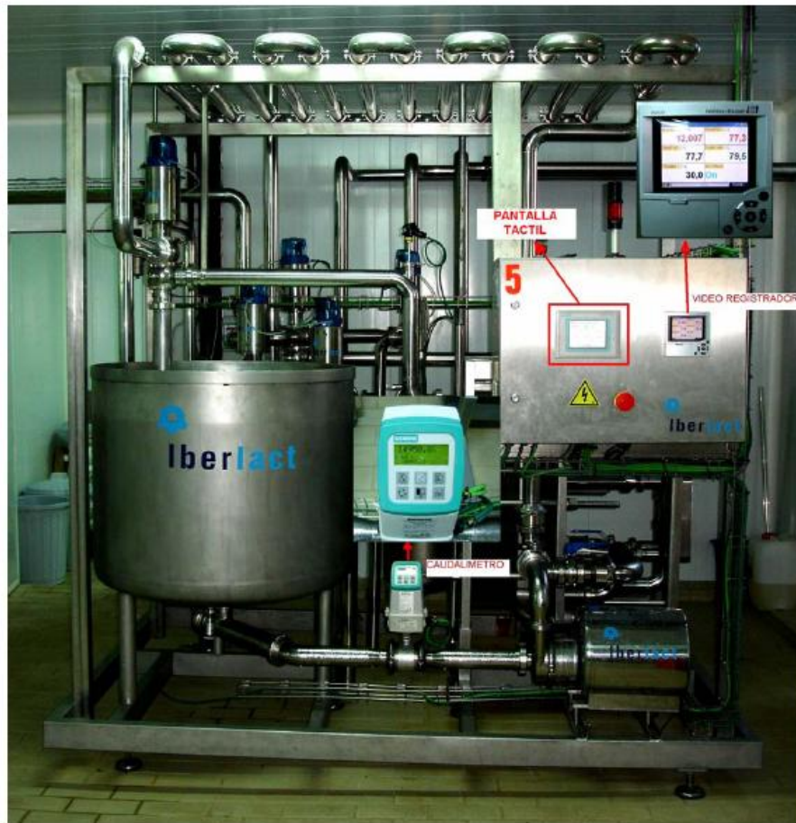
FIG 3: Ejemplo de Pasteurizador con pantalla táctil a color SIEMENS 5", caudalimetro SIEMENS y videoregistrador E&H:
